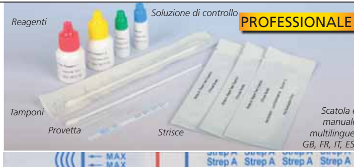
La riga blu indica un esito positivo, la riga rossa conferma la validità del test
